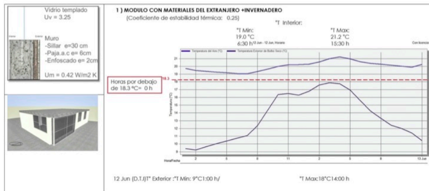
Figura 8. MÓDULO 2 con materiales del lugar más invernadero. Fuente: Elaboración propia
